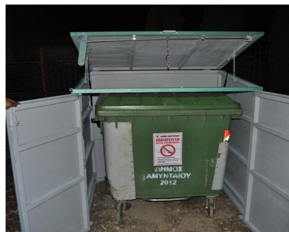
Εικόνα A-5: Μεταλλικό κέλυφος και κατασκευαστικές λεπτομέρειες των ενισχυμένων κάδων συλλογής απορριμμάτων
